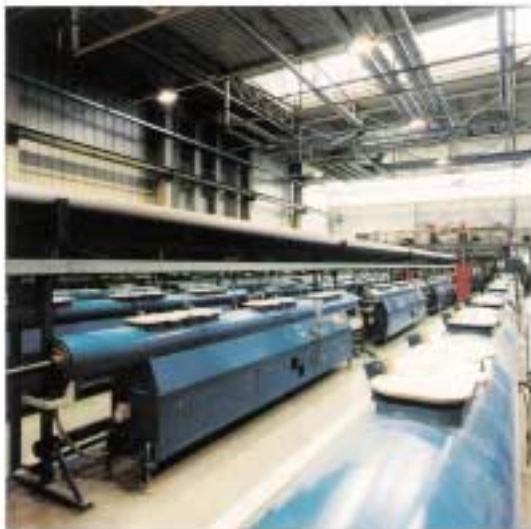
Bild 2: Gesamtansicht der Extrusion von Rohren aus dem Hochleistungs-Rohrwerkstoff PE-HD Fig. 2: Overall view of extrusion of high-performance HDPE material pipes
